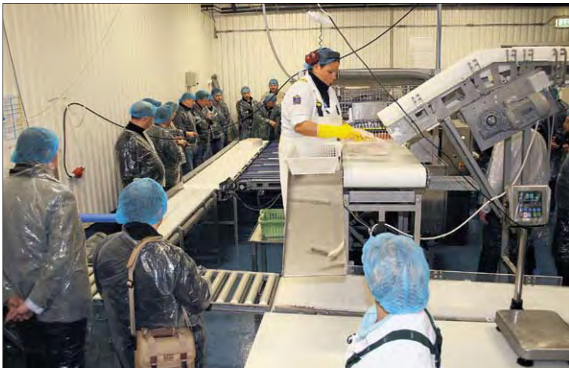
Á myndinni sést vinnslulínan hjá Nýfiski í Sandgerði ásamt starfsmanni sem vinnur við að meta gæði fisksins og að raða inn á flokkarann.
